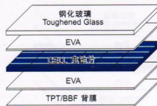
PV MODULE STRUCTURE 组件结构图
