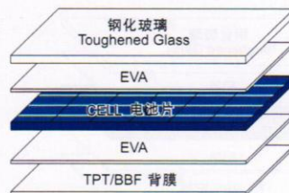
PV MODULE STRUCTURE 组件结构图
