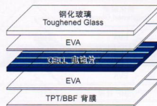
PV MODULE STRUCTURE 组件结构图
