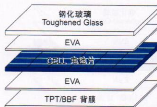
PV MODULE STRUCTURE 组件结构图
